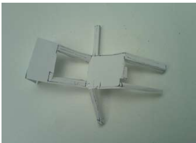
Fig. 26 En idé var att från en plåt stansa ut en stol i ett stycke som sedan bockas till.
